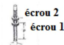
1. Ajuster l'écrou (1), la hauteur entre la base et l'écrou définit la profondeur du perçage. (P)
