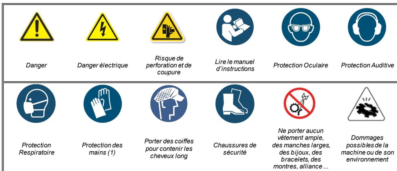
(1) Il n'est pas conseillé de porter des gants pendant l'usinage. Les réserver aux opérations de nettoyage, machine à l'arrêt ou pour toutes opérations présentant des risques de coupure, brûlure, pincement, etc.
